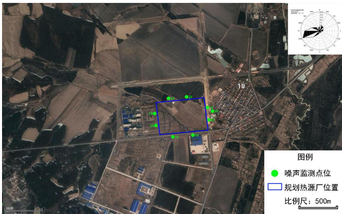
图 4-5-1 热电厂噪声监测布点图
